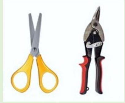
Для резки бумаги не требуется большой силы, а длинным лезвием легче резать по прямой линии, поэтому ножницы для бумаги имеют короткие ручки и длинные лезвия. Листовой металл намного сложнее разрезать, чем бумагу, значит потребуется большее плечо силы, поэтому ножницы для металла имеют длинные ручки.
