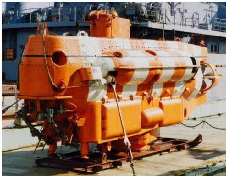
Рисунок 2 – Спасательный подводный аппарат проекта 18270
