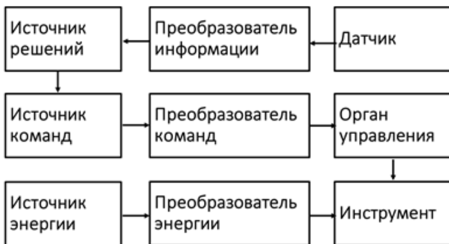
Рис. 7 Начало отсчета системности в ТРИЗ-2009. Схема полной технической системы.
