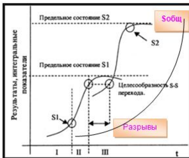
Рис. 1. Семейство S-кривых форм одной системы I, II, III - этапы жизненного цикла S1, S2 - переходные формы систем S общ - система, реализующая данный принцип
