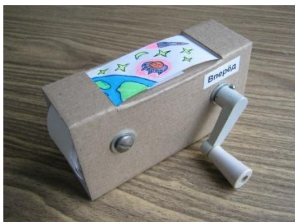
Рисунок 12 – Устройство (кассетного типа) для создания и просмотра рисунков и текста, содержащее столик для рисования, а также механизмы крепления и перемотки бумажного рулона
