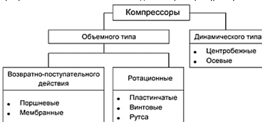
Рис. 1. Структурная схема технической системы "компрессор"
