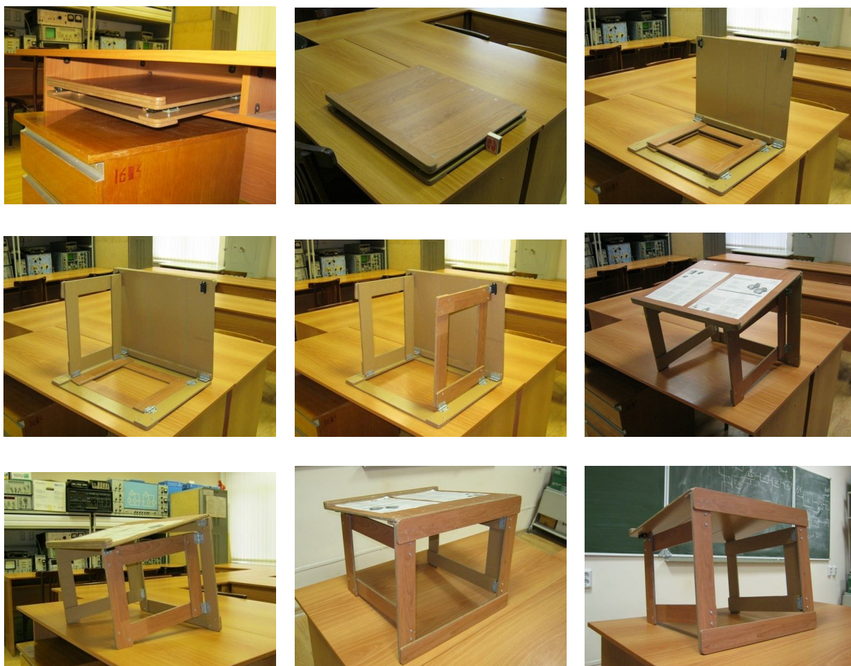
Рисунок 8 – Складная кафедра из 8-мм ламината
